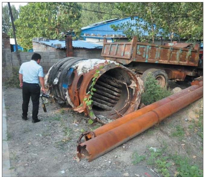
鄆城什集镇至尊木业有限公司门口已经拆除的小型燃煤炉。
