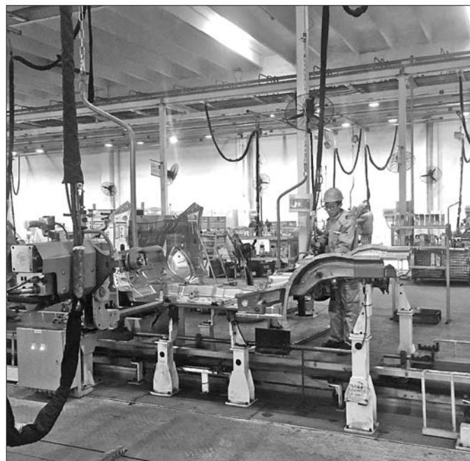
在比德文车间,工人正进行车身焊接。 本报记者 张玉岩 摄
