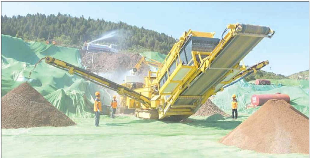
济南汉峪片区一工地,移动式破碎机将建筑垃圾重新加工制成空心砖。
