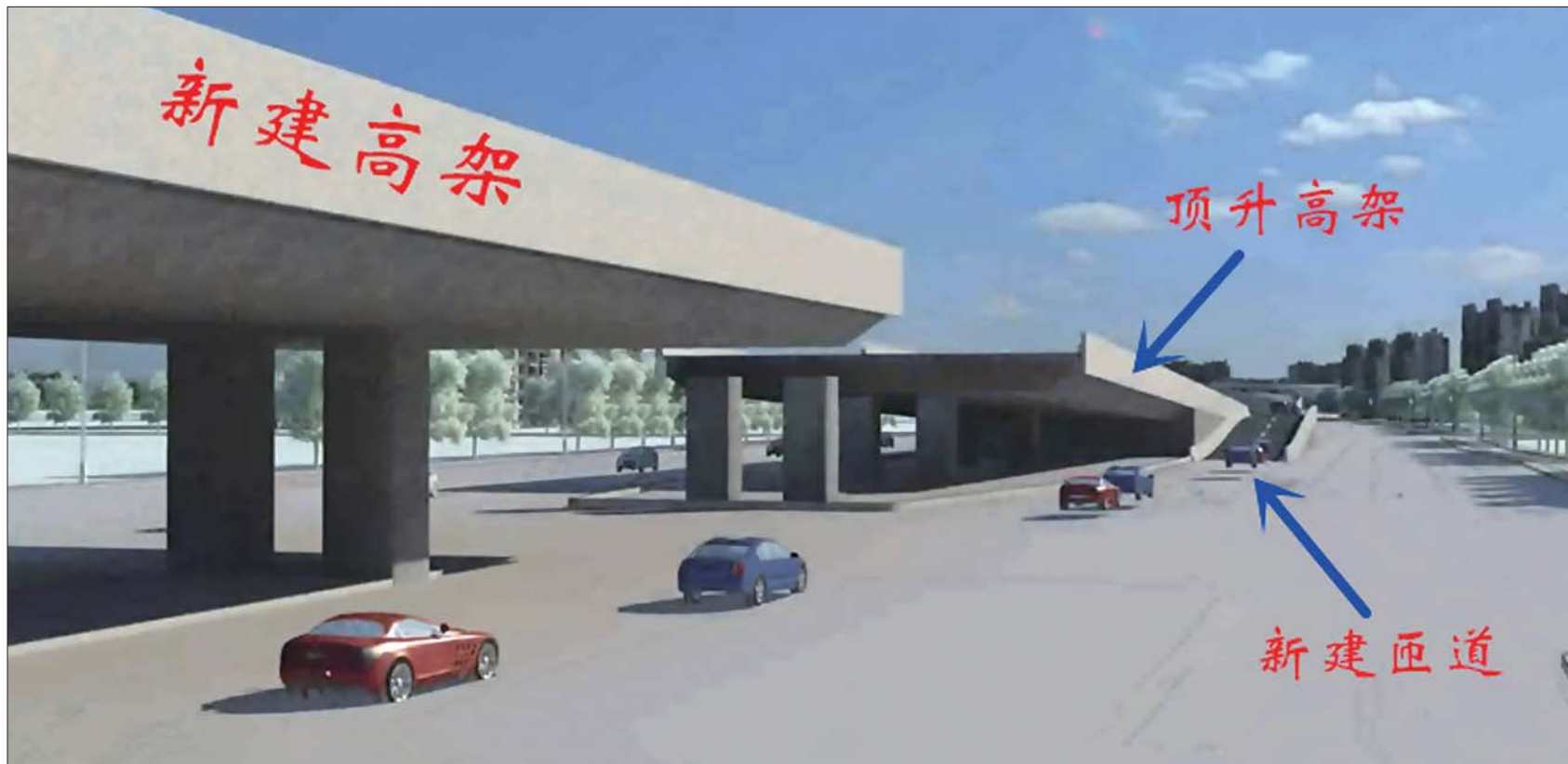
北园高架西延工程匡山立交“顶升”示意图。
