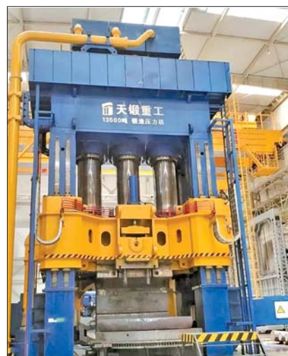
1.35万吨压力机可实现对大锻件高精度控制。
