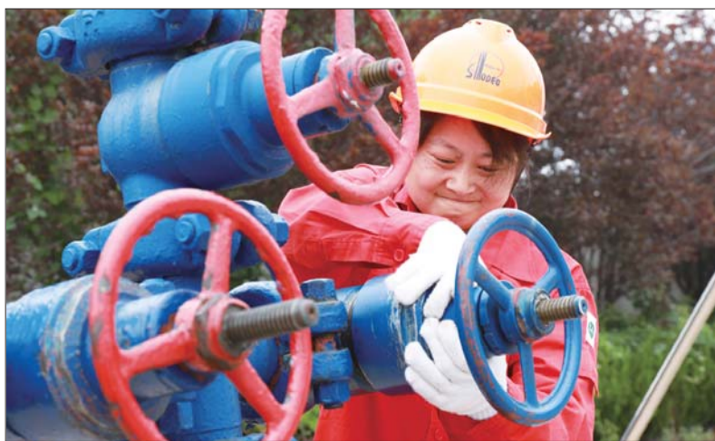
参赛选手更换注水井油管放空闸门闸板。
