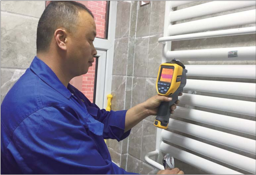
工作人员手持红外线测温枪进行气堵检测。
