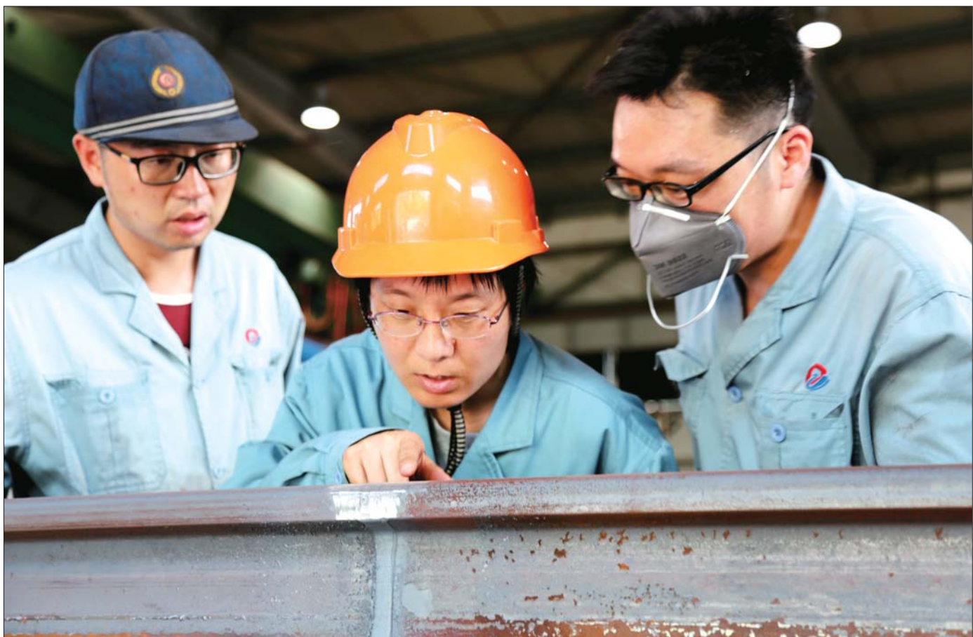
在所有的工序中,焊接是最重要的一环。图为有着“女汉子”之称的焊轨车间副主任周华正在测量钢轨焊缝误差。
