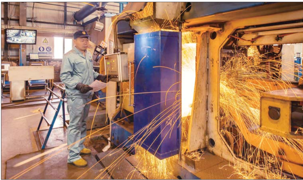
▲焊接钢轨要经过十几道工序,每道工序都关乎着焊接质量。图为工作人员正在进行焊接作业。
