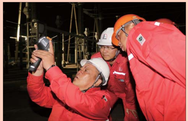
220千伏陈孤线送电前，值班人员对设备进行夜间测温。通讯员 卢宛林 摄
