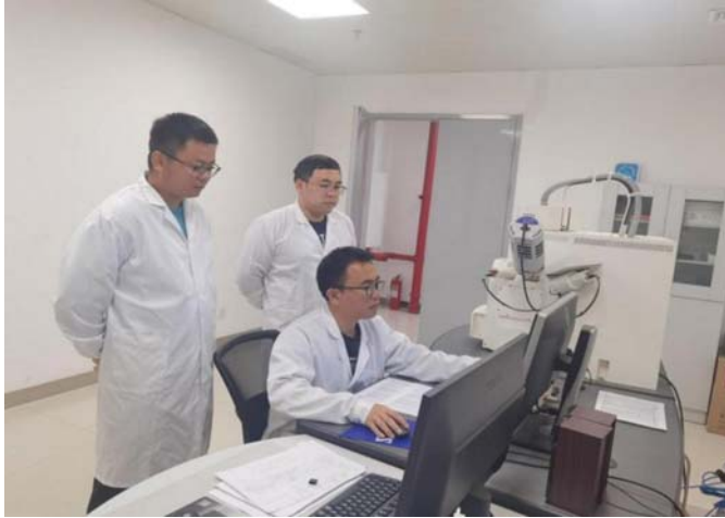
工作人员正在操作扫描电镜仪,进行SEM(微观形貌)、EDS(能谱分析)测试。
