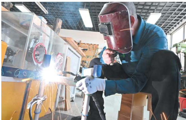
杨老师正在用焊接技术修理孩子们的凳子,学校里的桌椅等坏了他几乎都会修。
