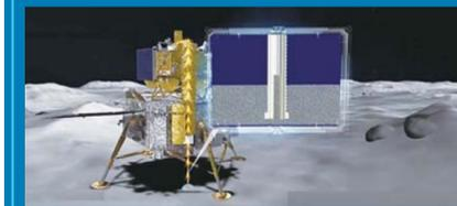
钻头向下钻进时，取芯袋会跟随取芯管向下运动，钻取到的月壤岩芯则会被顶进袋内。
