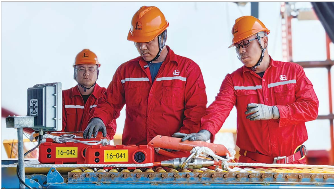
埕岛项目施工人员正在将OBN设备投入海里。
