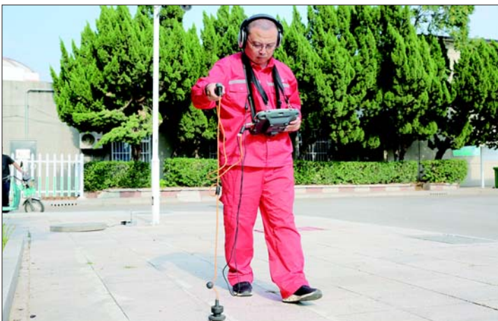
技术人员使用专业设备为甲方精准定位管线暗漏点，减少水量漏损。
