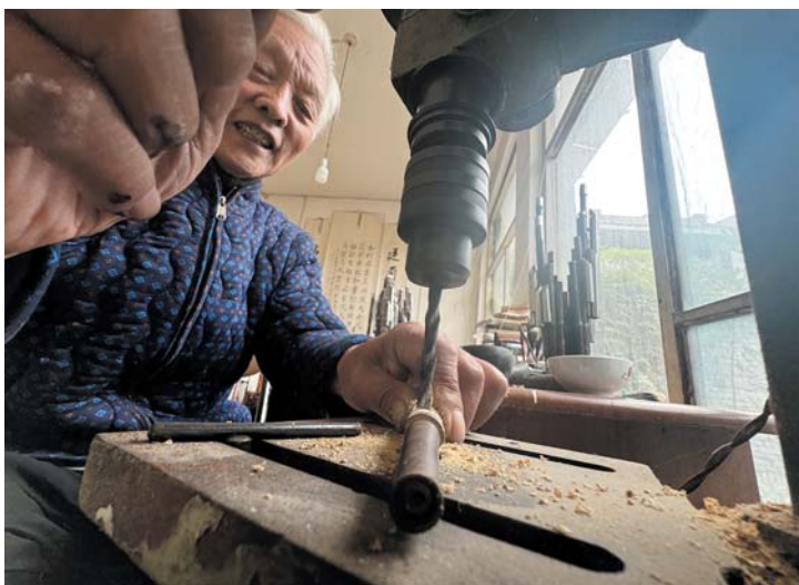
颜廷瑞正在用机器给紫竹打眼。
