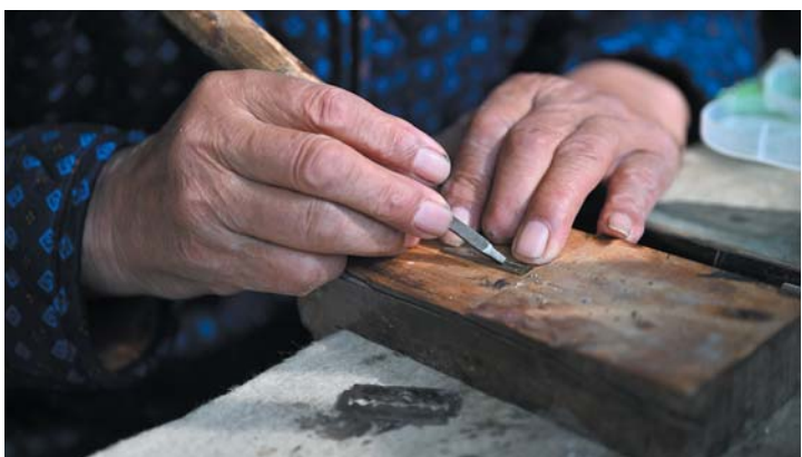
颜廷瑞正在精心打磨簧片。
