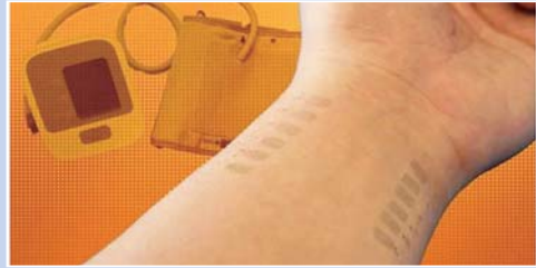
石墨烯“电子文身”能连续稳定监测血压。
