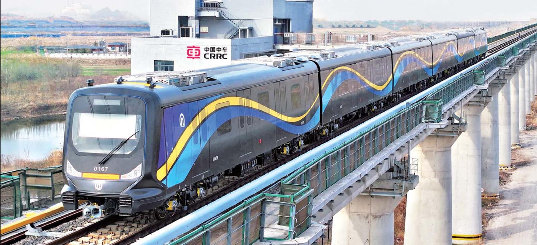
1月10日,随着一声清脆的鸣笛,青岛地铁集团与中车四方股份公司联合研制的全球首列碳纤维地铁列车“CETROVO 1.0碳星快轨”在青岛地铁1号线正式上线,投入商业运营。碳纤维地铁列车具有更轻更节能、强度更高、环境适应力更强、全寿命周期运维成本更低等技术优势。该车填补了碳纤维复材在地铁车辆主承载结构上商用的国际空白,引领我国地铁列车实现轻量化、绿色化全新升级。 赵波 通讯员 张鹤鸣 邓旺强 摄影报道
