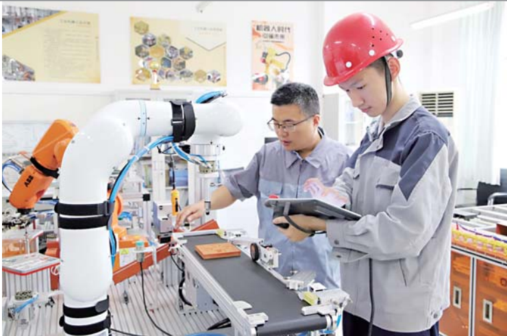
在济南市历城职业中等专业学校，教师正指导学生进行珞石机器人载物台皮带运输程序编写调试。
