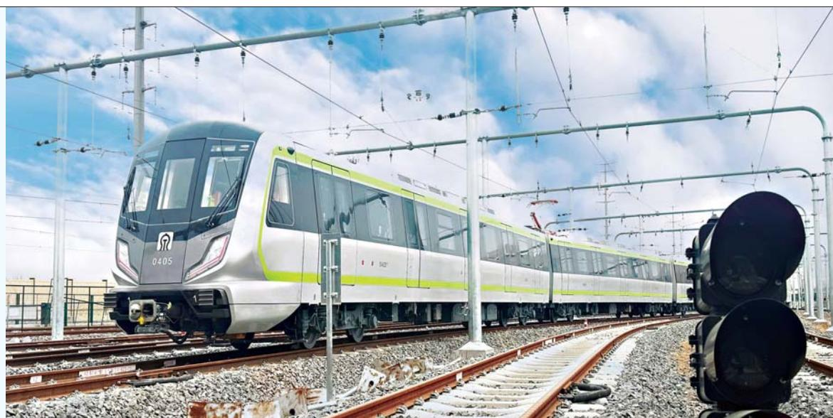
济南地铁4号线列车“揭开”面纱!列车首次采用A型车,最大载客量可达2590人,相比2号线提升约640人,采用GoA4等级全自动无人驾驶列车,设计运行速度为80km/h。 季明智 报道
