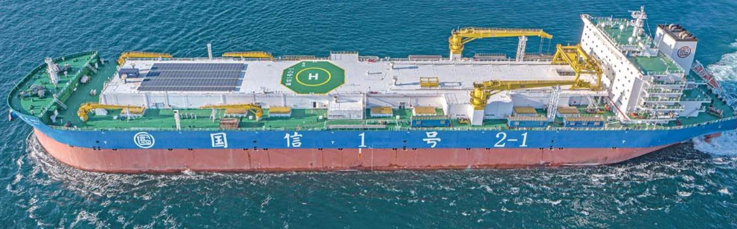
4月17日,由青岛国信集团投资建设的全球首艘15万吨级智慧渔业大型养殖工船“国信1号2-1”在中国船舶集团北海造船厂交付运营。“国信1号2-1”是全球首艘10万吨级养殖工船“国信1号”的升级版,船长244.9米,设置15个标准养殖舱、4个环形跑道池、22个养殖试验池。新一代“渔业养殖航母”将以“船载舱养”模式开展大黄鱼、鮰鳟鱼等名优鱼种养殖,设计年产能高品质鱼类约3600吨,再次刷新全球大型养殖工船纪录。 赵波 通讯员 陈晓莉 摄影报道
