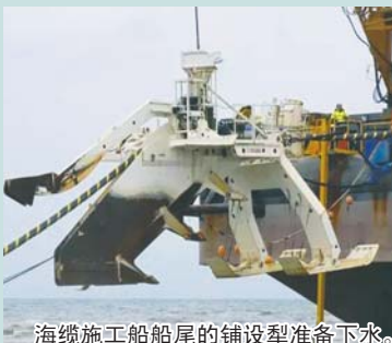
海缆施工船船尾的铺设犁准备下水。
