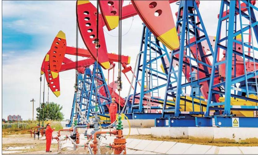
当前,正值秋季原油生产黄金季。为预防低温对稠油生产造成影响,胜利油田孤岛采油厂重点对稠油井电加热系统开展全面检查与维护,加大井场电加热设备巡检力度,通过核查运行数据、检查空气源热泵状态、优化加热温度等举措,保障稠油顺利举升,确保生产稳定有序。
