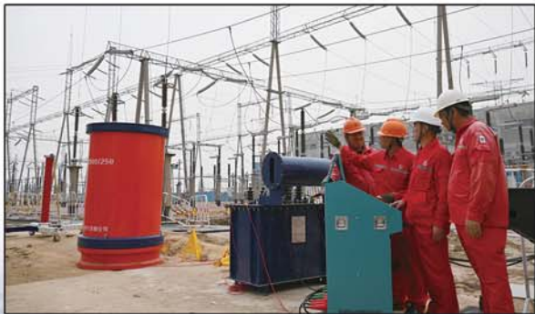
施工人员对220千伏GIS进行交流耐压试验。 通讯员 闫云海 摄
