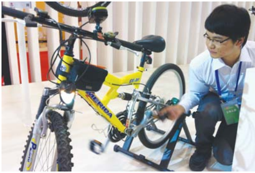
发电式自行车,可在骑车过程中给手机、MP3等设备充电。 蓝娜娜 摄
