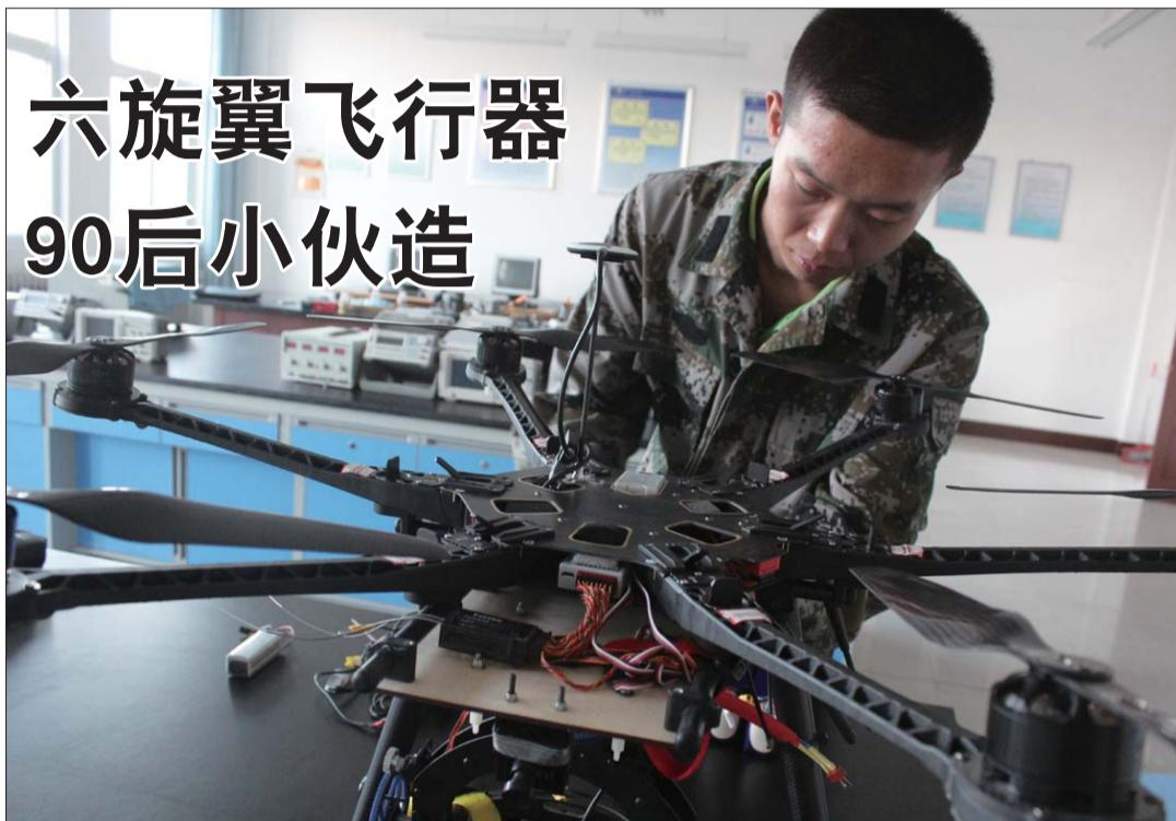
自己画图，自己切割材料，然后再找人加工，摔坏了就自己修，修好了继续试验。在滨州学院飞行学院，一位来自淄博的90后小伙，热衷于动手、热衷于钻研，设计出六旋翼飞行器，搭载上高清摄像头及各种传感器就可以实现空中消防火灾侦测。
