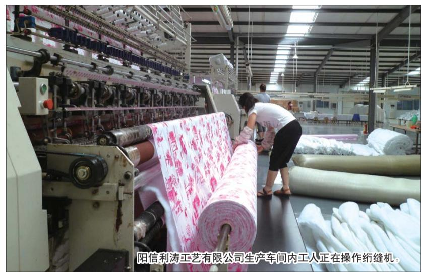
阳信利涛工艺有限公司生产车间内工人正在操作绗缝机。
