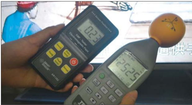
液晶电视屏幕前,磁场辐射显示为0.23 \mu T,电场辐射显示为2.525V/m,都比较小。
