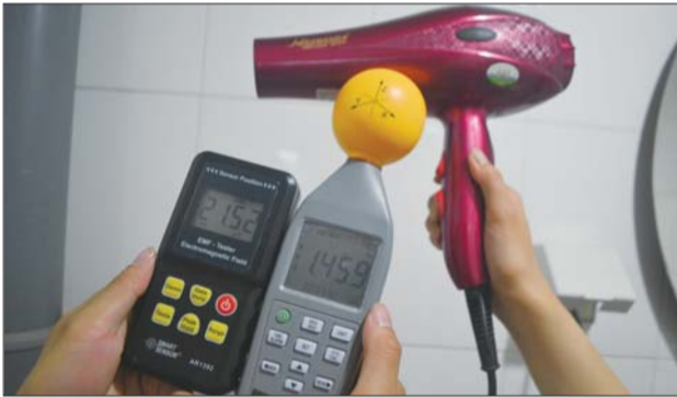
电吹风按到低档时,磁场辐射检测仪显示为21.52 \mu T,电场辐射显示为1.459V/m,磁场辐射是所有检测家电中数值最大的。
