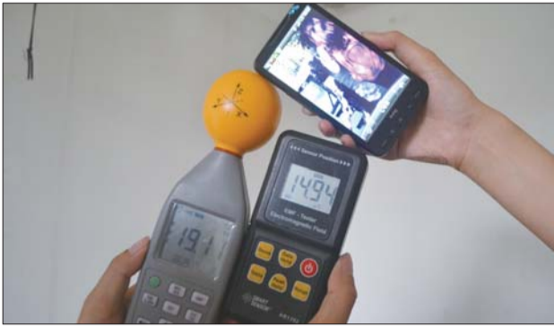
手机在来电接通瞬间,磁场显示是14.94 \mu T,电场是19.11V/m,数值较大。
