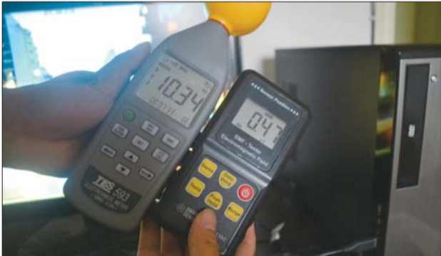
电脑液晶显示器磁场显示为0.47 \mu T,电场辐射为10.3V/m。
