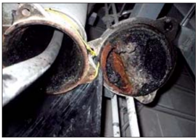
腐蚀老化的管道
