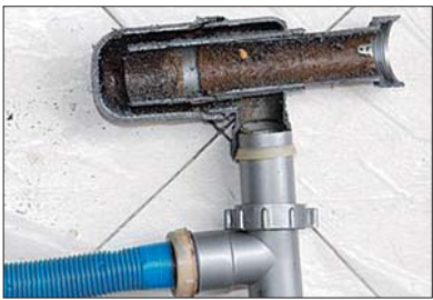
腐蚀老化的管道
