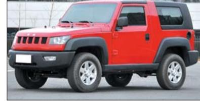
210mm，具有良好的通过性。BJ40将搭载2.4L发动机，最大功率105KW，最大扭矩217N·m，与之匹配的是5速手动变速器。该车配有分时四驱系统，有两驱高速、四驱高速和四驱低速模式，进而满足不同路况的驾驶。
