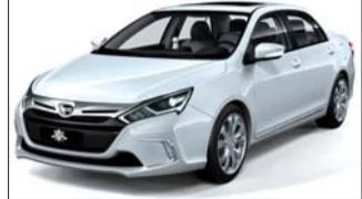
门板处打开。秦的电机的最大功率是110kW、最大扭矩是250Nm，汽油发动机是1.5TI涡轮增压发动机，最大功率是113kW/5200rpm，最大扭矩是240Nm/1750-3500rpm，总功率217kW，综合扭矩479Nm。从数据上看，它的动力绝对不输一般的汽车。
