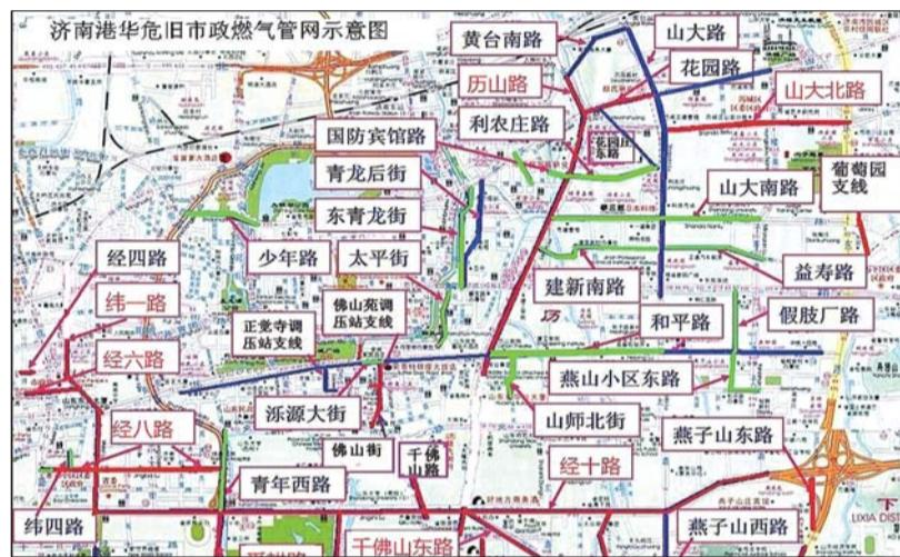
图为16日济南港华燃气公布的省城部分地区危旧市政燃气管网示意图。红色为未改造铸铁管,蓝色为已改造铸铁管,绿色为已改造已切换铸铁管。
