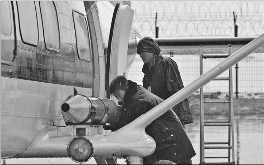
17日,青岛进行飞机增雨作业,图为技术人员在为增雨飞机安装烟弹。 通讯员 杨凡 摄
