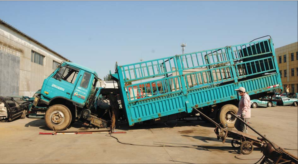
拆解企业工作人员对报废黄标车进行“一解二”。
