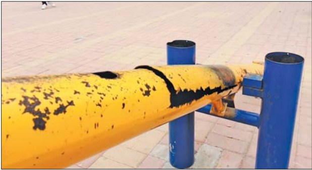
化纤厂小区广场上,跷跷板主体出现裂缝。 本报记者 王倩 摄
