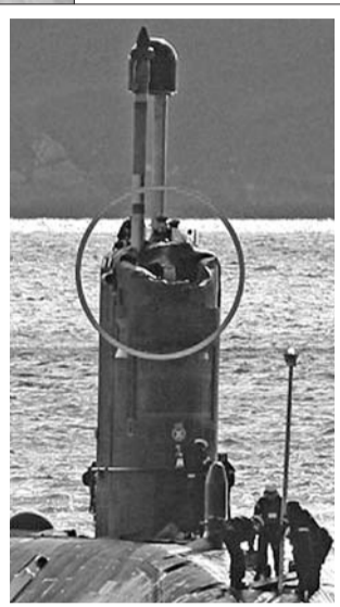
英国海军“天才”号核潜艇指挥台围壳顶部撞出一个直径约1.8米的大坑。
