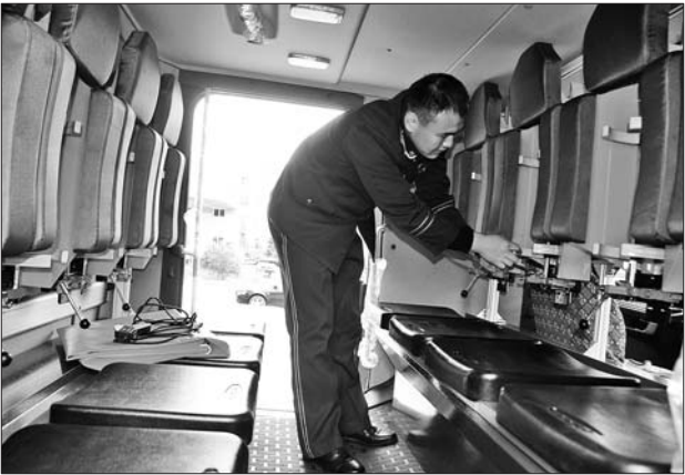
▲新车后排有8个座位，每个座位都配备了空气呼吸器装置。 记者 王震 摄
