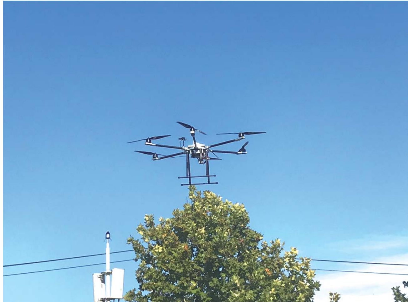
无人机高空基站为灾区提供应急通信保障。
