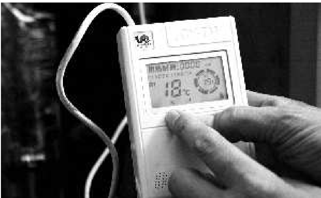
这是康桥水岸小区一户居民家中安装的热计量表。 本报记者 吴凡 摄
