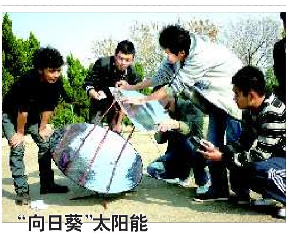
10 日下午 2 点, 五名中国石油大学(华东)大二在校生正在操场上试验他们刚发明的装置——基于跟踪式太阳能供热的半导体温差发电装置。陈晨告诉记者, 这个发电装置完全是他们自主研发的, 可自主追踪太阳光线, 预计 12 月初完成, 并且是全国首创。图为小组成员们正在测量阳光焦点温度。
