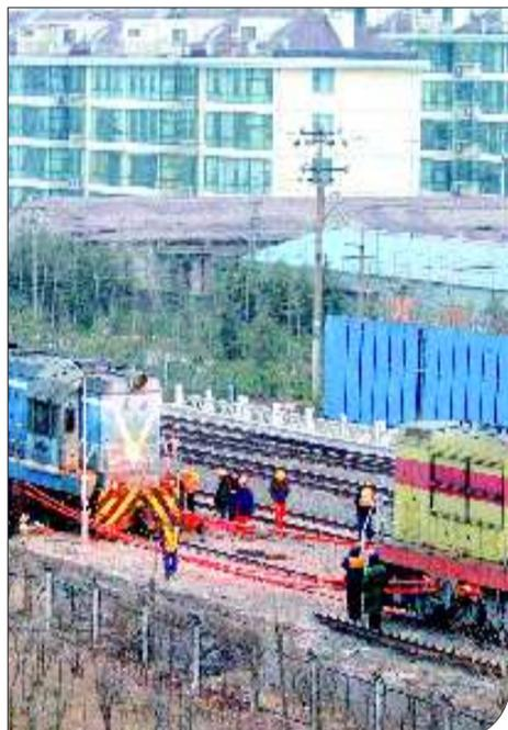
起重机将脱轨的火车头吊起放平。徐升 马峰 摄
