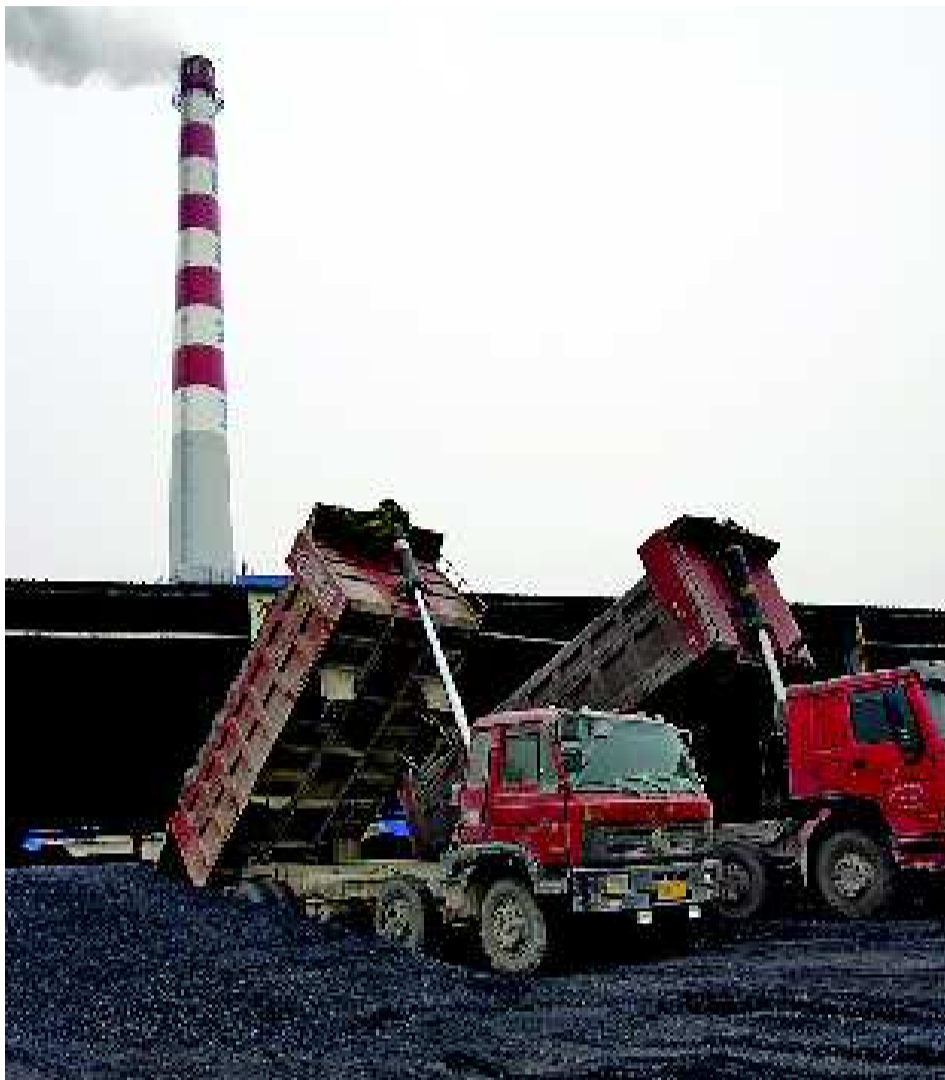
为防止被淋湿,运送煤炭的卡车直接将煤炭倾倒入干燥棚中。
