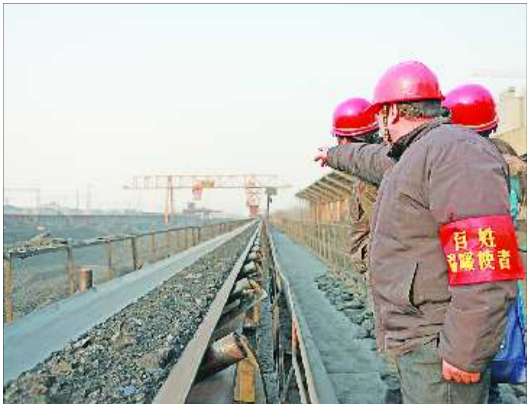
1月18日，北郊热电厂的工人正在用装卸桥把煤从煤场运到传输皮带上。
