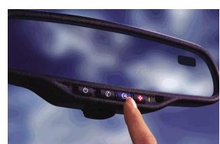
安吉星系统有“红、白、蓝”三个控制按钮，车主可通过一键式沟通界面迅速连接专业的安吉星客户服务顾问，帮助车主解决在行车中所遇到的各种问题。红色按钮可以说是“救命按钮”，它可以提供被撞自动求助功能、安全气囊爆开自动求助功能、紧急救援协助功能和爱心救助路人四项
