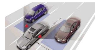
配有车道稳定系统的车辆在不小心偏移至旁边的车道时，系统会发出警告。为实现该功能，一般会在前挡风玻璃处安装摄像头，以识别车道标识，当车辆“无意识”地偏向另一车道时，车辆的方向盘会发生三次抖动，以示警告。
