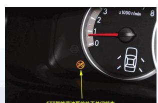
STT智能节油系统通过电脑判断车辆的状态，例如车辆在红灯、堵塞等停滞状态时，电脑可以
