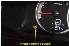
STT智能节油系统通过电脑判断车辆的状态,例如车辆在红灯、堵塞等停滞状态时,电脑可以
