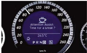
睡意探测器的功能就如同防火墙,你如果登录了不良网站,就容易中病毒,开车瞌睡也一样容易出事故。该系统设有70个不同的参数来检测驾驶者的疲劳程度。当探测器检测到驾驶者有瞌睡的“意向”时,仪表盘上会出现“一杯咖啡”图像和“您是否该稍作休息一下?”的文字,同时还会发出铃声对驾驶者进行“警告”。
