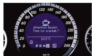
睡意探测器的功能就如同防火墙，你如果登录了不良网站，就容易中病毒，开车瞌睡也一样容易出事故。该系统设有70个不同的参数来检测驾驶者的疲劳程度。当探测器检测到驾驶者有瞌睡的“意向”时，仪表板上会出现“一杯咖啡”图像和“您是否该稍作休息一下？”的文字，同时还会发出铃声对驾驶者进行“警告”。
