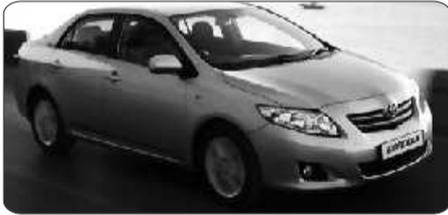
同为万辆俱乐部常客的新卡罗拉,也在去年更新换代。新卡罗拉最大的亮点在于动力系统方面,其首次引入海外版车型所搭载的2.0L四缸自然吸气引擎,其最大输出功率为106千瓦,使其驾驶乐趣更为出色。此外,老款车型1.6L和1.8L引擎得以保留,但1.8L引擎在动力输出方面进行了调校,最大输出功率提升3千瓦,达到103千瓦。
