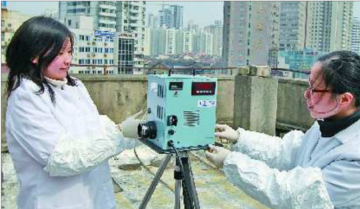
3月15日,上海市辐射环境监督站工作人员在操作气碘采样器。该仪器可准确判断空气中是否含有放射性碘。 新华社发
