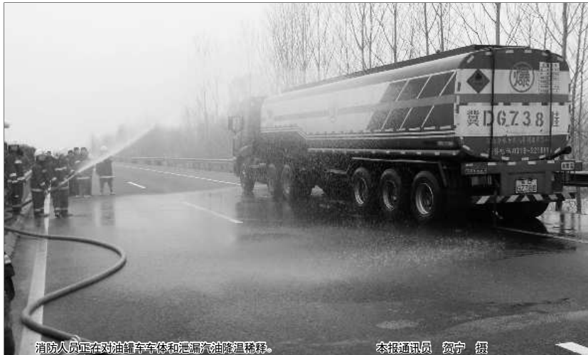
消防人员正在对油罐车车体和泄漏汽油降温稀释。
