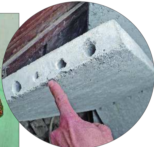
▲断成两半的水泥板里看不到钢筋。
