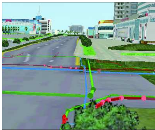
地下管网空间三维演示图。其中横向道路是泰安路,纵向道路是烟台路。天蓝色线为供水管,褐色线为排水管,粉红色线为燃气管,黄色线为热力管,绿色线为电信管,大红色线为供电管。网上的点状物代表阀门井、维修井。(日照市城市建设档案馆供图)
