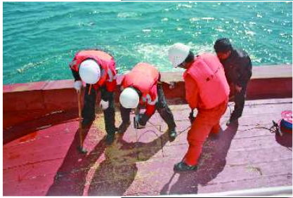
▲救助人员用电锯在船底切割出一个方洞。
