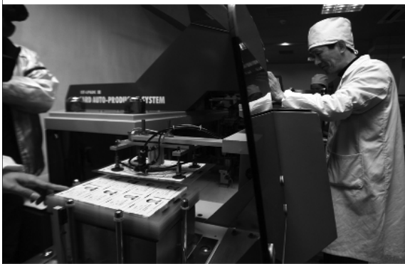
身份证通过机器进行平压冲切、电写入。
